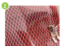
PVC-Folie mit Teflon-Füsschen und Stichlänge 3,5 Füsschenbreit auf das Netz nähen. Dabei das ganze vorsichtig unter der Nähmaschine führen.
